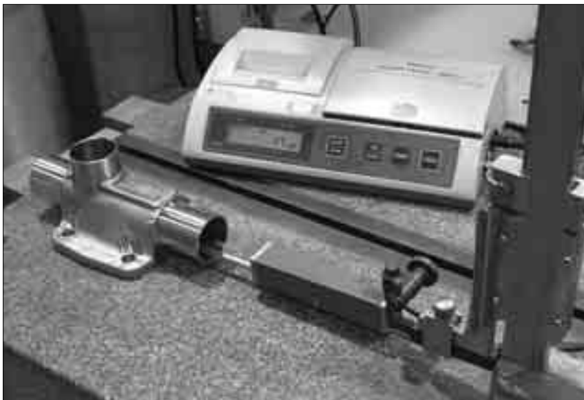
Control de perfilómetro para acabado de la superficie de la válvula
